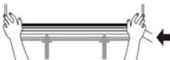
Pasul 8: Suspențați unitatea interioară
