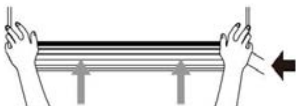
Korak 8: Objesite unutrašnju jedinicu
