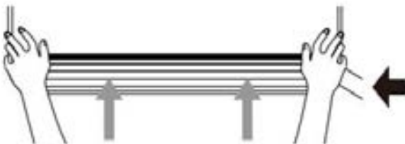
Krok 8: Zavesenie interiérovej jednotky
