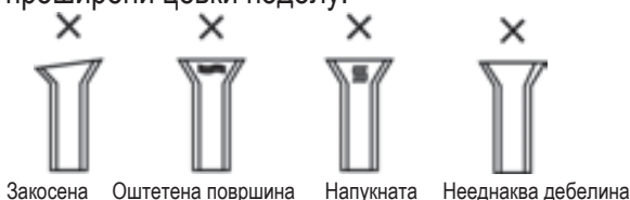
Закосена Оштетена површина Напукната Нееднаква дебелина
