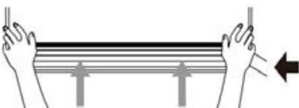
Korak 8: Kačenje unutrašnje jedinice
